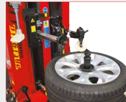
positionnement automatique outils pour cycle manuel
