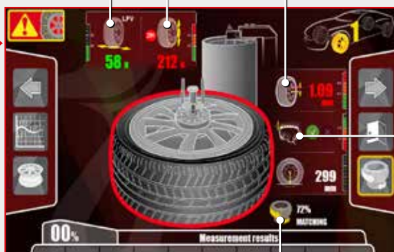
LFV Laterale Kraftschwankungen
