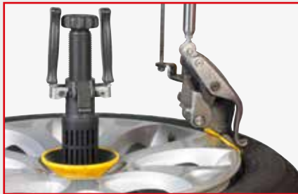
Demontage der oberen Wulst
