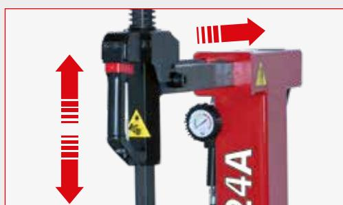
**Bras horizontal** (hexagonal) télescopique pour une mise en place rapide de la tourelle par rapport à la jante.
