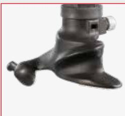
L'outil de démontage et de montage est une nouveauté appréciée de ce démonte-pneus. De conception nouvelle, l'ajout de l'**aileron arrière** offre un support important lors du montage, facilite l'entrée du pneu dans la jante et évite tout endommagement potentiel du pneu. Il existe également des protections en plastique pour éviter les marques sur les jantes. De grande efficacité aussi sur les pneus RFT, UHP et BSR en combinaison avec le presse-talon, disponible comme accessoire.
