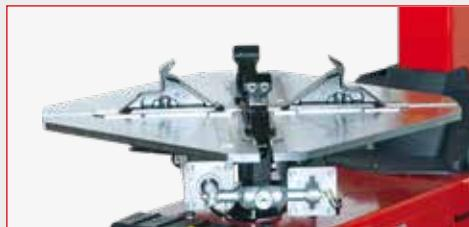
**Etau** avec double vérin pneumatique en mesure de bloquer solidement tous les types de jantes.
