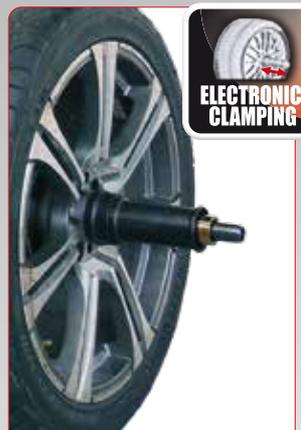
**Sistema automático eletromecânico** de bloqueio da roda que **reduz o tempo de trabalho** e **aumenta a precisão de centragem**.
