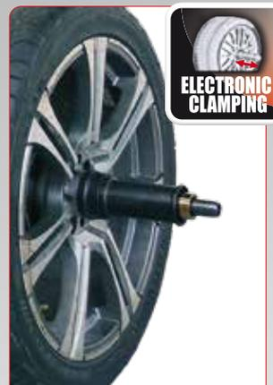
**Système automatique électromécanique de blocage de la roue** qui **réduit les temps de travail** et augmente la précision de centrage.
