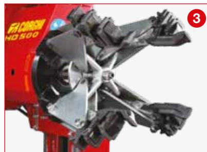
Garras de bloqueio de topo de gama. Bloqueio de 14" até 26". Desempenho máximo graças aos 7 métodos de bloqueio disponíveis. **Diâmetro mínimo de garra: 100 mm.** São fornecidos passadores de plástico para suporte do aro, com diferentes espessuras, para um perfeito bloqueio do aro.
