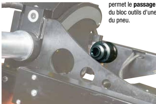
Le dispositif **S.T.S.** (Side To Side) permet le **passage automatique** du bloc outils d'une face à l'autre du pneu.
