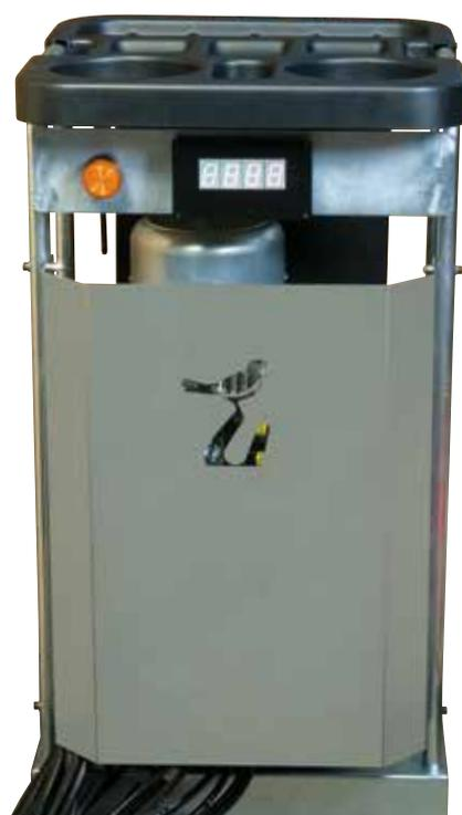
L'unité électro-hydraulique avec écran est positionnable dans la position la plus pratique et permet de mémoriser toutes les données du pneu installé sur la machine.
