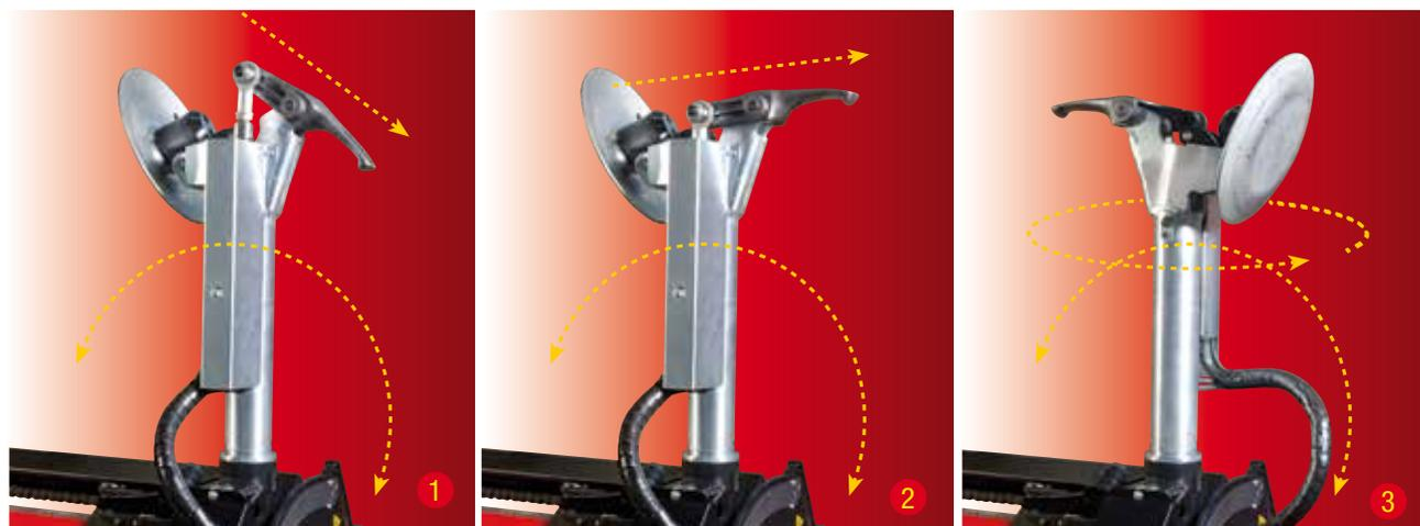
Séquence mouvements automatiques du disque détalonneur :
