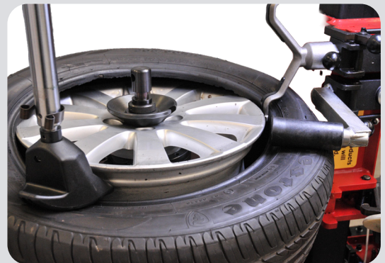
Pneumatischer Andruckarm + serienmäßige Andruckrolle
