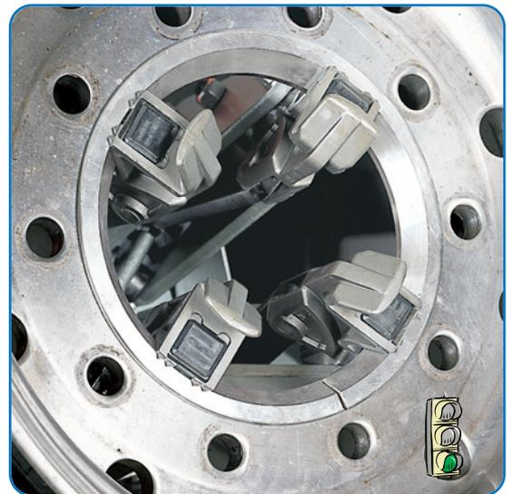
➤ Procedimiento de bloqueo correcto con anillo. Ningún contacto directo entre llanta y mordaza. Máxima protección de la llanta
