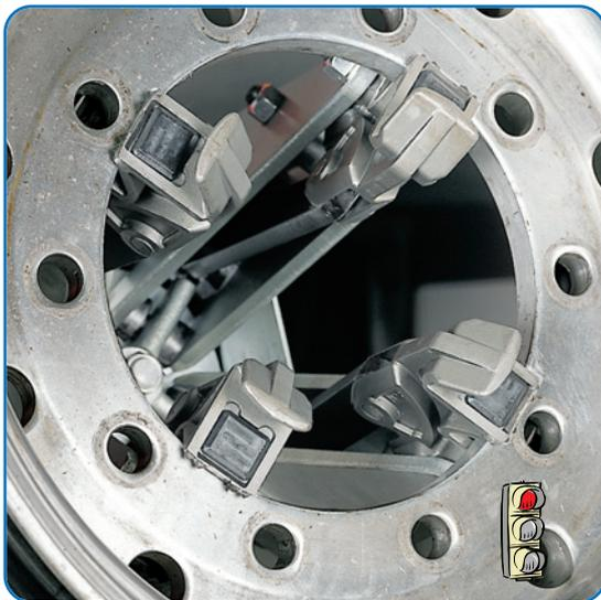
➤ Procedimiento erróneo de bloqueo. Contacto directo con la mordaza. Inevitable que la llanta sufra daños
