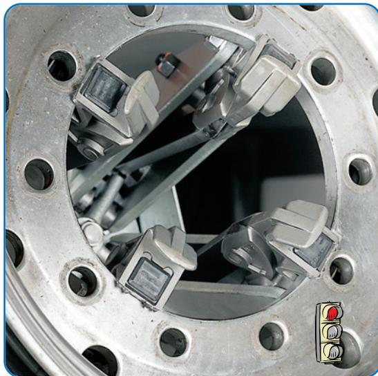
➤ Procédure de blocage erronée. Contact direct avec la griffe. Endommagement sûr de la jante
