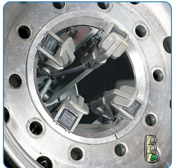
➤ Procédure de blocage correcte avec anneau. Aucun contact direct entre jante et griffe. Protection maximum de la jante
